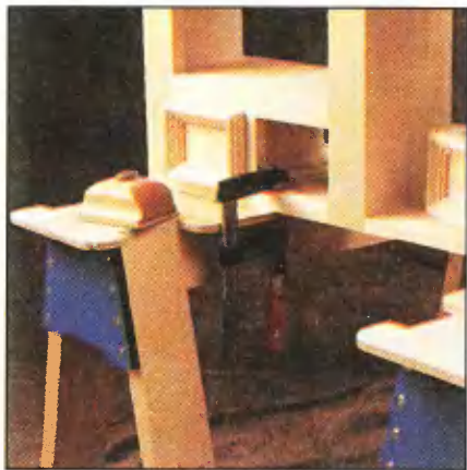
Выступ над царгами обеспечивает достаточно места для крепления струбцин.
