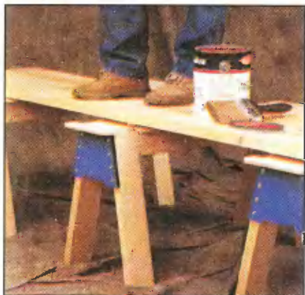
Несколько крепких досок, положенных поперек козлов, позволяют быстро соорудить надежные подмости.
